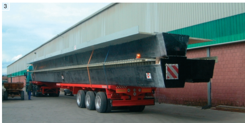
Fot. 1, 2. Most z kompozytów o długości 46 m wykonany na północy Hiszpanii w 2003 roku Fot. 3. Element konstrukcji mostu wykonany z materiałów kompozytowych
